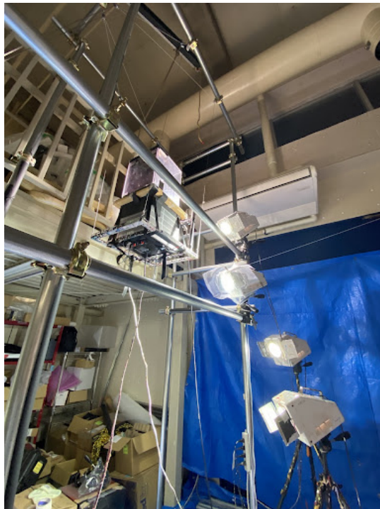
2000フレーム/秒の高速度カメラによって撮影し、スローモーションで変化する液体をとらえる
